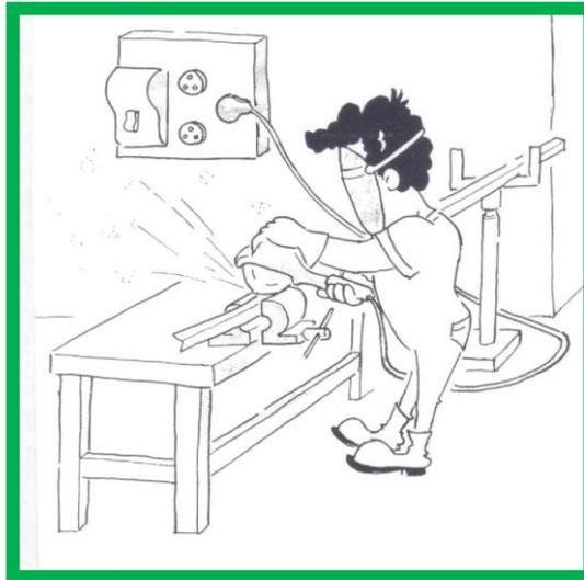
**“JAMAIS RETIRE A CAPA DE AÇO DE PROTEÇÃO DA ESMERILHADEIRA POIS A SUA FUNÇÃO É A DE EVITAR QUE UM PEDAÇO DE DISCO ROMPIDO ATINJA O USUÁRIO”**
